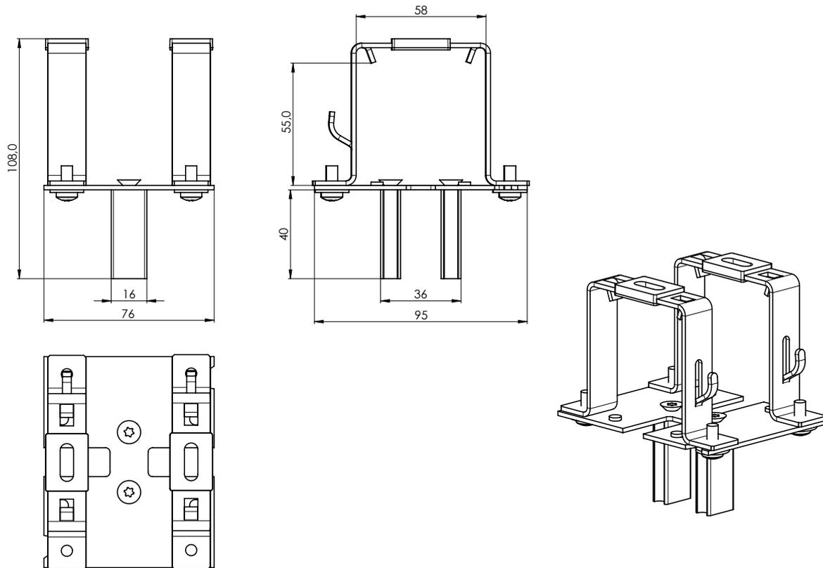
**Hanger der oberen Leiste mit dem Halter (Al) P002/9 (2-01628) der Führungsleiste P016/2**
