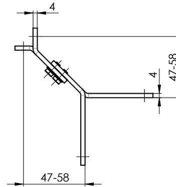
Bei einem Profil 40x40 mm beträgt der Mindestabstand der Achse der Führung von der Ankerfläche 70 mm!
