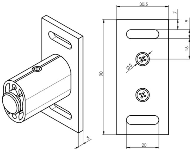
Befestigung der Führungsschiene
