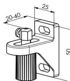
Spannwinkel einfach, 30 - 75 mm P032/2 (2-01648)
