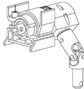
Getriebe mit Sechskantöffnung für die Kurbelbetätigung
