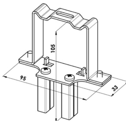
**Verschluss P002/41 (2-00588) der Führungsleiste P016/1 und P016/2**
