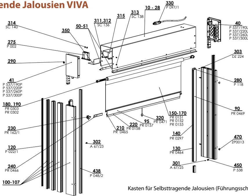
Kasten für Selbsttragende Jalousien (Führungsschiene RS75)
