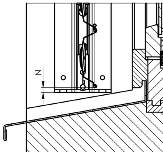
Der Spalt zwischen der Unterkante der letzten Lamelle und dem Ende der Führungsschiene  $N = 10 \pm 5$  mm.
