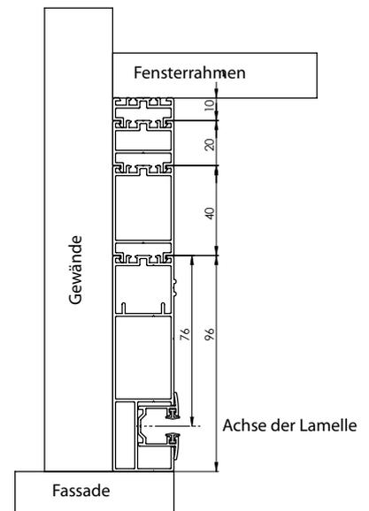
**FÜLLPROFILE FÜR DIE FÜHRUNGSLAUFLEISTE P 020 UND P 081**
