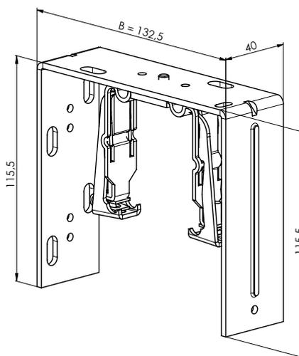
Doppelhalter mechanisch - verstellbar kurz 106-163 mm
