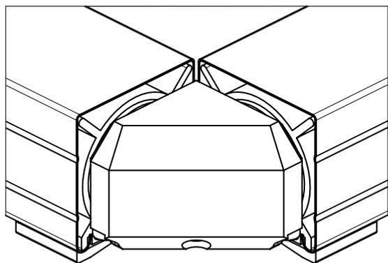
Detail der Verbindung der Lamellen und der unteren Eck-Leisten
