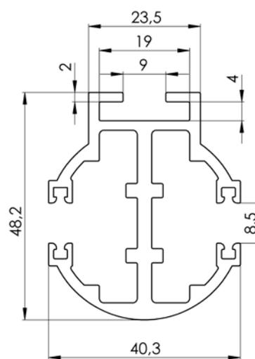
**Führungsleiste FIX (P018/2 FIX)**
