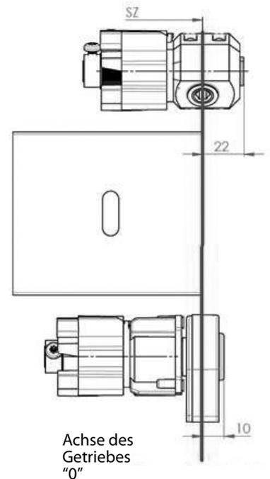
Getriebe für die Schnurbetätigung
