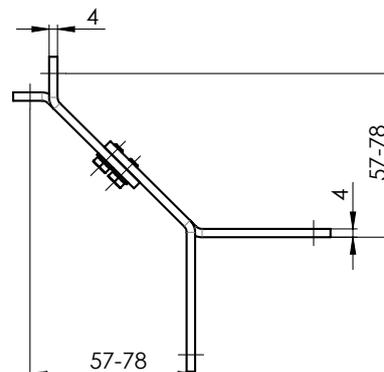
**Führungsschienenhalter, eckig außen 100 – 140 P 098/2 (2-01152-PU11)**
