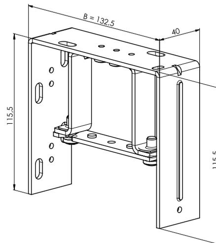
Doppelhalter - verstellbar kurz mit Al Halter 106-163 mm
