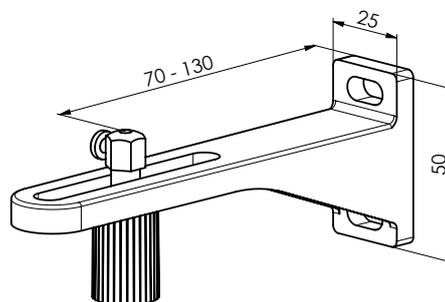
Spannwinkel einfach, 90 - 165 mm P032/4 (2-01646)
